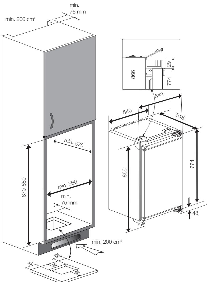
Enerji tasarrufu için buzdolabı arkasında yeterli hava sirkülasyonu sağlanmalıdır. Bu amaçla buzdolabının içine yerleştirileceği ahşap kabının arka yüzeyi kapatılmamalıdır.
