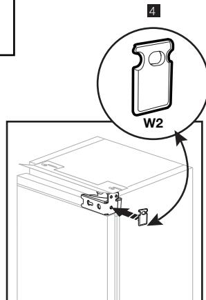
**Not:** 2-3 numara ile gösterilen montaj adımında üst bağlantı plastikini kaydırabilmek için bağlantının yapıldığı vidaları tam sıkmayın.
