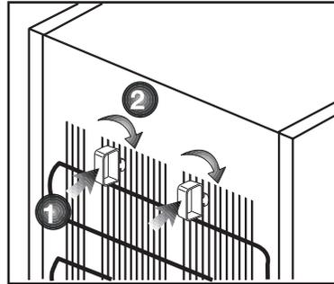
gezeigt an. Die Kunststoffkeile sorgen für den richtigen Abstand zwischen Kühlschrank und Wand – und damit für die richtige Luftzirkulation. (Die Abbildung dient lediglich zur Orientierung und muss nicht exakt mit Ihrem Gerät übereinstimmen.)
