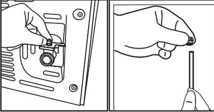
2. Befestigen Sie den Wasserschlauch durch das Drücken nach unten fest an den Adapter am Schlauchende.
