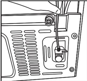
3. Befestigen Sie die Anschlussmuffe am Adapter mit dem Schlauchende. Sie können die Anschlussmuffe mithilfe eines Rohrschlüssels oder einer Zange montieren.
