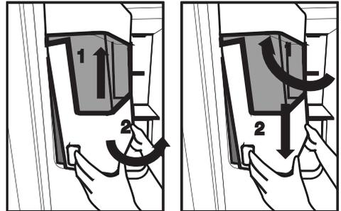
Wenn Sie Schwierigkeiten beim Wiedereinsetzen des Behälters haben, drehen Sie das Drehrad um 90° und installieren Sie es erneut wie auf Abbildung 3 gezeigt.
