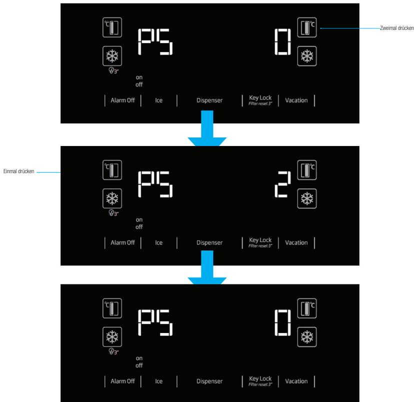
„Trennen Sie den Kühlschrank bei Anzeige des Bildschirms PS0 vom Stromnetz und schließen Sie ihn wieder an. Dadurch wird der Filterzähler aktiviert. Nach 130 Tagen wird die Filterwarnung-LED am Display aktiv. Halten Sie nach Erneuerung des Filters die Tastensperre-Taste 3 Sekunden gedrückt, damit der Filterzähler einen neuen 130 Tage-Zyklus beginnt.“
