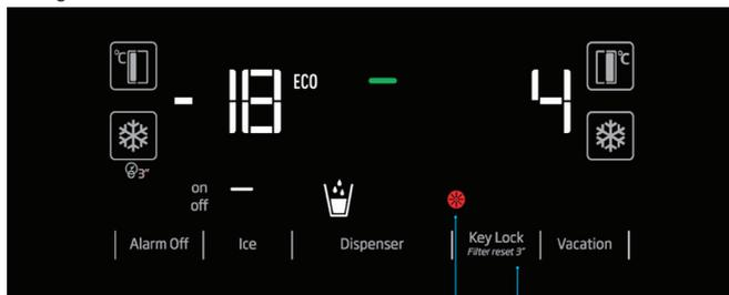
Drücken Sie die Taste zum Zurücksetzen der Filterzeit 3 Sekunden, während die Warn-LED aktiv ist.
