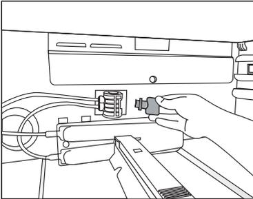
4. Verriegeln sie den Deckel des Wasserfilters indem Sie es in die Vorrichtung setzen und nach vorne schieben.
