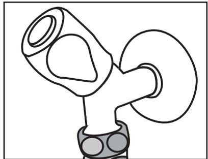
3. Stecken Sie die Anschlussmuffe auf den Wasserschlauch.
