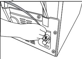
2. Schließen Sie das andere Ende des Wasserschlauchs an der Wasserpumpe an, indem Sie den Schlauch in den Schlauchanschluss der Pumpe schieben.
