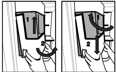
Wenn Sie Schwierigkeiten beim Wiedereinsetzen des Behälters haben, drehen Sie das Drehrad um 90° und installieren Sie es erneut wie auf Abbildung 3 gezeigt.
