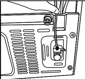
3. Befestigen Sie die Anschlussmuffe am Adapter mit dem Schlauchende. Sie können die Anschlussmuffe mithilfe eines Rohrschlüssels oder einer Zange montieren.
