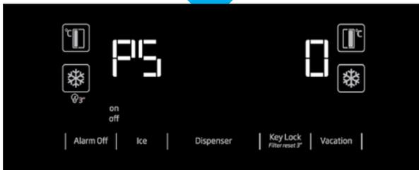
„Trennen Sie den Kühlschrank bei Anzeige des Bildschirms PS0 vom Stromnetz und schließen Sie ihn wieder an. Dadurch wird der Filterzähler aktiviert. Nach 130 Tagen wird die Filterwarnung-LED am Display aktiv. Halten Sie nach Erneuerung des Filters die Tastensperre-Taste 3 Sekunden gedrückt, damit der Filterzähler einen neuen 130 Tage-Zyklus beginnt.“
