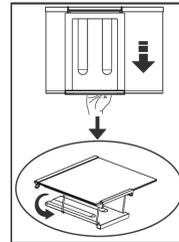
Um die Weinablage zusammenzusetzen, müssen Sie zunächst die Glasablage aus dem Kühlschrank nehmen. Halten Sie dann das Kunststoffteil fest und ziehen Sie es an den vorderen und hinteren Bereichen zur Seite. Jetzt können Sie das Gerät mit der Weinablage verwenden.
