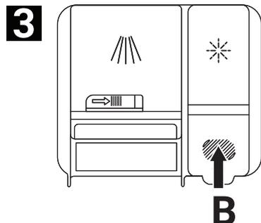
4. Falls nach dem Spülen Flecken am Geschirr verbleiben, stellen Sie eine höhere Stufe ein. Sollte eine bläuliche Färbung nach dem Abwischen des Geschirrs von Hand zurückbleiben, wählen Sie eine niedrigere Stufe. Ihr Gerät ist ab Werk auf Position 3 voreingestellt.
