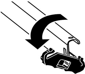
Öffnen Sie die Schienenabdeckungen gemäß der Zeichnung. Entfernen Sie Ihren Korb von der Schiene. Anschließend reinigen Sie die Schienen ausschließlich mit einer Bürste.
