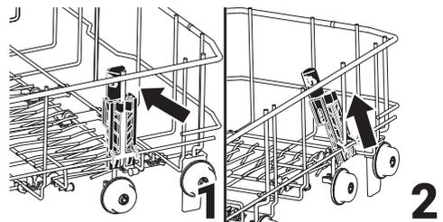
**i** Die TrayWash müssen gemäß den Abbildungen 1 und 2 für Leistungstests entfernt werden, die gemäß den Normen durchgeführt werden müssen.
