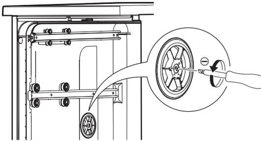
Die Einstellung der Glaspflegefunktion wird verwendet, um den Wasserhärtegrad des vorgewärmten Waschwassers im Geschirrspüler einzustellen, wobei die Einstellung entsprechend dem Wasserhärtegrad erfolgen muss. Die Einstellung erfolgt mit Hilfe eines breiten und flachen Schraubendrehers, der zum Drehen des mechanischen Schalters für die
