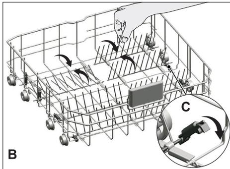
**i** Falls der Halter an der Spitze gefasst und in eine horizontale Position gebracht wird, kann sich der Halter verbiegen. Daher sollte der Halter durch Fassen in der Mitte und Drücken in Pfeilrichtung in eine horizontale oder vertikale Position gebracht werden.
