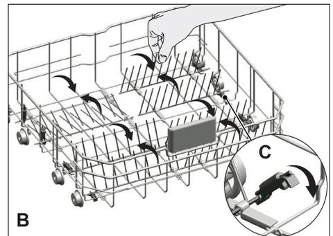
**i** Falls der Halter an der Spitze gefasst und in eine horizontale Position gebracht wird, kann sich der Halter verbiegen. Daher sollte der Halter durch Fassen in der Mitte und Drücken in Pfeilrichtung in eine horizontale oder vertikale Position gebracht werden.
