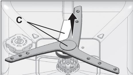
Zum Ausbauen und Reinigen der unteren Sprüharmbaugruppe halten Sie sie an den in der Abbildung gezeigten Punkte (C) mit einer Hand fest und ziehen Sie sie nach oben. Montieren Sie die Teile nach der Reinigung in umgekehrter Reihenfolge wieder.
