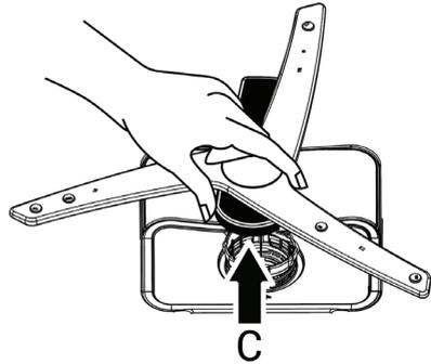
Zum Ausbauen und Reinigen der unteren Sprüharmbaugruppe halten Sie sie an den in der Abbildung gezeigten Punkte (C) mit einer Hand fest und ziehen Sie sie nach oben. Montieren Sie die Teile nach der Reinigung in umgekehrter Reihenfolge wieder.
