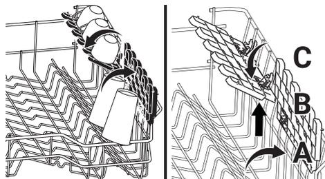
**i** Die Ablagen können wie erforderlich durch Verschieben in eine niedrigere oder höhere Position oder durch Schließen zur Schaffung von mehr Platz im unteren Korb genutzt werden.
