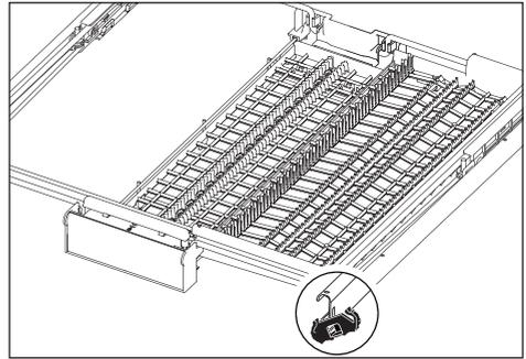
Wenn sich die mittlere Ablage in der unteren Position befindet, können Sie Gegenstände wie Espressotassen, Löffel usw. darauf ablegen. Wenn die seitlichen Ablagen nach außen geschoben sind, kann die zentrale Ablage durch Ziehen des Hebels angehoben werden, woraufhin das System verriegelt wird.
