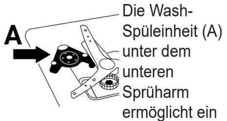
besseres Reinigen für Ihre stark verschmutzte Flaschen und Geschirrtteile, die sich gemäß dem ausgewählten Programm auf der rechten Seite des unteren Korbs befinden.
