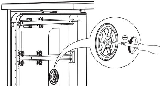
Die Einstellung der Glaspflegefunktion wird verwendet, um den Wasserhärtegrad des vorgewärmten Waschwassers im Geschirrspüler einzustellen, wobei die Einstellung entsprechend dem
