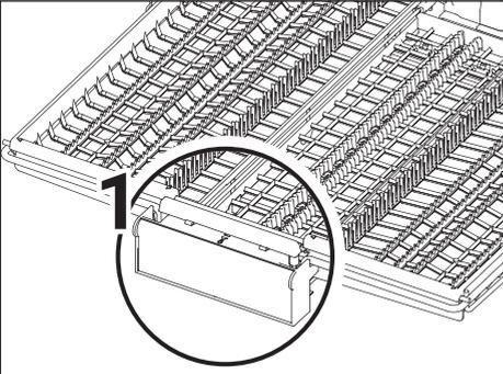
In Modellen mit flexibler Besteckschublade können Sie die mittlere Ablage des Korbs durch Drücken des Hebels (1) am Griff auf die unterste Position einstellen wie in Bild B abgebildet. Damit wird das System freigegeben. Dadurch können die rechten und linken Ablagen als bewegliche Teile genutzt werden wie in Bild C und D abgebildet.
