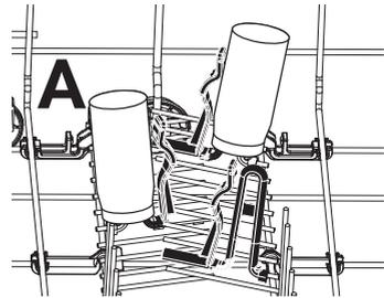
Und wenn Sie den faltbaren Draht in die vertikale Position bringen, können Sie Ihr Geschirr platzieren, ohne die Halter zu entfernen.
