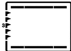
Das Gargut wird gleichzeitig von oben und unten erhitzt. Diese Betriebsart eignet sich beispielsweise für Kuchen, Gebäck und Aufläufe. Nur ein Blech verwenden.
