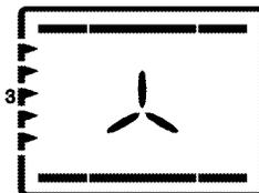
Durch den Lüfter wird heiße Luft von den oberen und unteren Heizelementen gleichmäßig und schnell im Backofen verteilt. Nur ein Blech verwenden.
