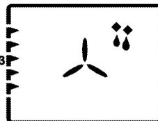
Der Backofen wird nicht beheizt. Nur der Lüfter (in der Rückwand) arbeitet. Gefrorene Lebensmittel werden langsam bei Zimmertemperatur aufgetaut, heiße Lebensmittel abgekühlt.
