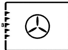
Durch den Lüfter wird heiße Luft vom Umluftgestützten Heizelement mit hoher Geschwindigkeit im Backofen verteilt. Diese Betriebsart eignet sich zum Garen auf unterschiedlichen Einschubebenen; in den meisten Fällen ist kein Vorheizen erforderlich. Mehrere Bleche können verwendet werden.
