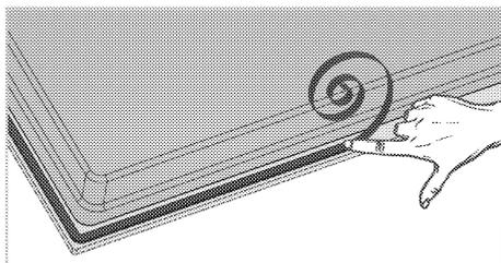
4. Fixați arcurile de montare, introducându-le și înșurubându-le prin orificiile carcasei inferioare, conform figurii.
