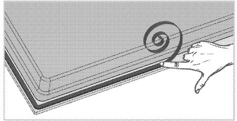
4. Befestigen Sie die Montagefedern, stecken Sie sie wie abgebildet durch die Löcher am unteren Gehäuse und schrauben sie fest.
