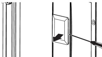
3. Heben Sie die Glasabdeckung des Leuchtmittels mit einem Schraubendreher an. Entfernen Sie zuerst die Schraube, wenn in Ihrem Produkt eine Schraube an der quadratischen Lampe vorhanden ist.
