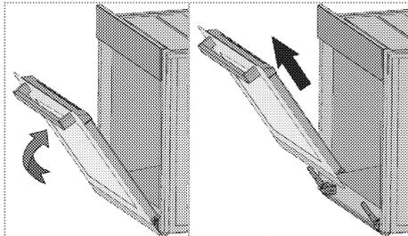
4. Ziehen Sie die halb geöffnete Tür nach oben, um sie aus dem rechten und linken Scharnier und zu entfernen.
