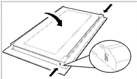
2. Ziehen Sie das oben auf die Vordertür montierte Kunststoffteil zu sich, indem Sie auf die Druckpunkte auf beiden Seiten des Teils drücken und entfernen Sie das Kunststoffteil.
