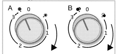
2. Ein "Klicken" ist zu hören, wenn der Zonendurchmesser geändert wird. » Alle zentralen und äußeren Oberflächen der Mehrfachkochzonen beginnen zu funktionieren.
