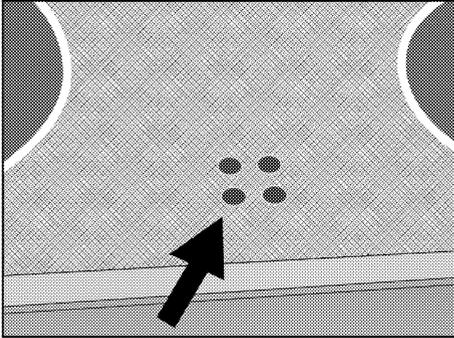
Die Warnanzeige für die heiße Zone zeigt die Position des eingeschalteten Kochfelds an und leuchtet nach dem
