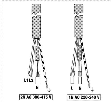
2. Bei Einphasenanschluss erfolgt der Anschluss der Kabel wie folgt:
