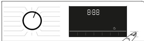
Dacă doriți să anulați funcția Timp de finalizare, apăsați butonul On/Off (Pornire/Oprire) pentru a opri și reporni mașina.
