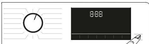
3 Ușa de încărcare este blocată. Simbolul Ușă blocată apare pe ecran după ce ușa de încărcare este blocată.
