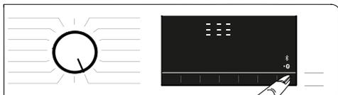
Atunci când este activată funcția Remote Control, puteți numai să opriți mașina și să urmăriți starea mașinii de spălat. Prin intermediul aplicației, toate operațiunile pot fi efectuate cu excepția funcției blocare acces copil.
