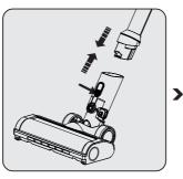
اضغط على زر تحرير فرشاة التربو الكهربانية بفرشاة التربو الكهربائية وادفعها في اتجاه السهم باتجاه الأنبوب.
