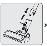
اضغط على زر تحرير فرشاة التربو الكهربائية بفرشاة التربو الكهربائية وادفعها في اتجاه السهم باتجاه الأنبوب.
