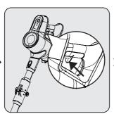
اضغط على زر التشغيل/ إيقاف التشغيل لتشغيل الجهاز. يبدأ الجهاز في العمل عند أقل مستوى طاقة عند الضغط على
