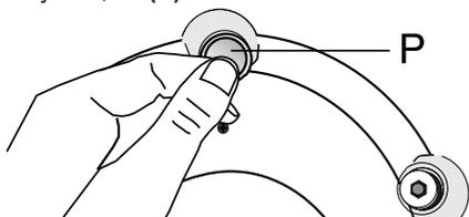
Затяните все гайки вручную. Не используйте для затяжки гаек гаечный ключ.
