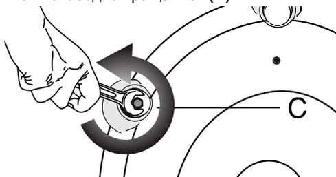
2. Осторожно выкрутите и выньте предохранительные транспортировочные болты.
