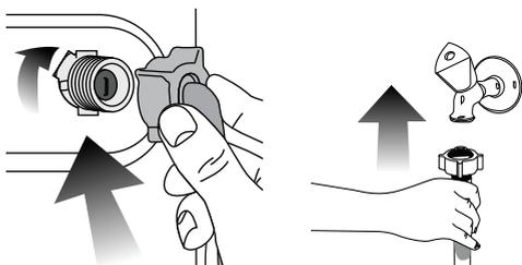
После подсоединения шлангов полностью откройте краны для проверки мест подсоединения на наличие протечек. В случае протечки закройте кран и отвинтите гайку. Проверьте прокладку и тщательно затяните гайку еще раз. Во избежание возможных протечек и связанного с этим ущерба закрывайте краны, когда машина не используется.
