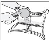
Une couche peut se former sur les pores du filtre et entraîner un bouchage du filtre après avoir utilisé la machine pendant un certain temps. Lavez le filtre à l'eau chaude pour enlever la couche qui se forme sur la surface du filtre. Séchez le filtre complètement avant de le réinstaller.
