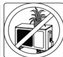
Pastikan tidak ada yang menutupi inlet dan outlet udara
