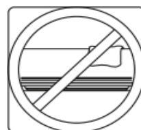
Pastikan tidak ada yang menutupi inlet dan outlet udara
