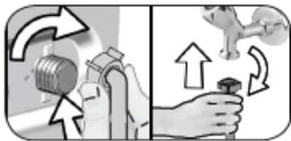
1. Mengencangkan mur selang dengan tangan. Jangan menggunakan alat saat mengencangkan mur.
