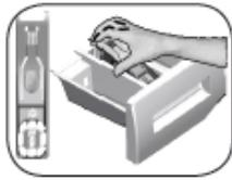
Bersihkan laci deterjen secara berkala (setiap 4-5 siklus pencucian) seperti ditunjukkan di bawah ini untuk mencegah akumulasi serbuk deterjen pada waktunya. Angkat bagian belakang siphon untuk menghapusnya seperti yang diilustrasikan. Jika lebih dari jumlah normal campuran air dan pelembut mulai berkumpul di kompartemen pelembut, siphon harus dibersihkan.
