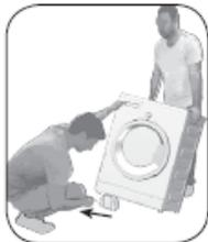
Miringkan mesin ke belakang untuk melepaskan penguat pengemasan. Melepaskan penguat pengemasan dengan menarik pita. Jangan melakukan operasi ini sendirian.
