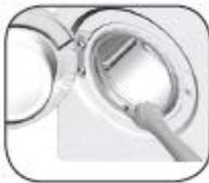
Setelah setiap mencuci pastikan bahwa tidak ada zat asing yang tersisa di drum. Jika lubang di bawah yang ditunjukkan pada gambar diblokir, buka lubang menggunakan tusuk gigi. Zat logam asing akan menyebabkan noda karat di dalam drum. Bersihkan noda pada permukaan drum dengan menggunakan agen pembersih untuk besi tahan karat. Jangan pernah menggunakan wol baja atau wol kawat. Ini akan merusak permukaan yang dicat, dikrom dan plastik.
