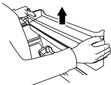
2. Tenere entrambi i lati del serbatoio dell'acqua e rimuovere a un angolo di 45°.
