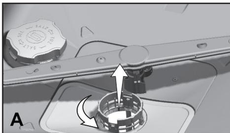
1. Ruotare il gruppo microfiltro (1) e filtro grosso (2) in senso antiorario e tirare per estrarlo dall'alloggiamento
