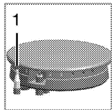
1. Disattivazione di sicurezza del gas
