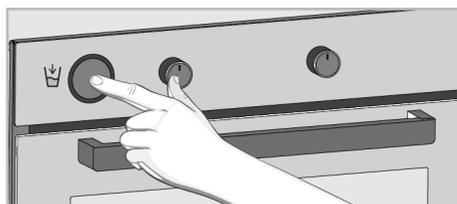
3. Posizionare il serbatoio dell'acqua nella sua sede e premerlo. L'acqua inizia a riempire la vaschetta che si trova sul fondo del forno.
