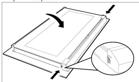
2. Tirare verso di sé il componente in plastica, fissato sulla parte superiore dello sportello anteriore, premendo contemporaneamente sui punti di pressione su entrambi i lati del componente e rimuoverlo.
