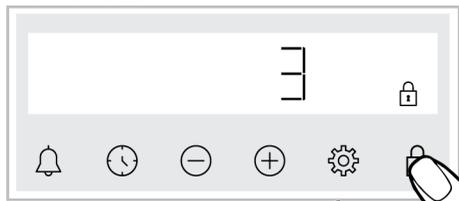
» Sul display appare il simbolo e inizia il conto alla rovescia 3-2-1. Al termine del conto alla rovescia, viene attivato il blocco dei tasti. Quando si tocca un tasto qualsiasi con il blocco tasti impostato, il timer emette
