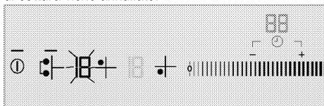
**i** Se si tocca uno dei tasti di selezione della zona di cottura di sinistra mentre è attiva la zona di cottura grande, le zone di cottura vengono separate e si spengono.
