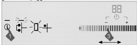
3. Toccano l'area di regolazione o facendo scorrere il dito lungo l'area, regolare il livello di temperatura tra 0 e 19.
