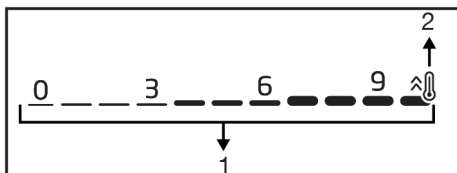
Illustrazione 1: Area di configurazione per l'impostazione del livello di temperatura
