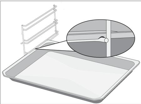
**Richtige Platzierung des Drahtgitters und der Ablage auf den Teleskopschienen - Bei Modellen mit Drahtfachböden und Teleskopmodellen**
