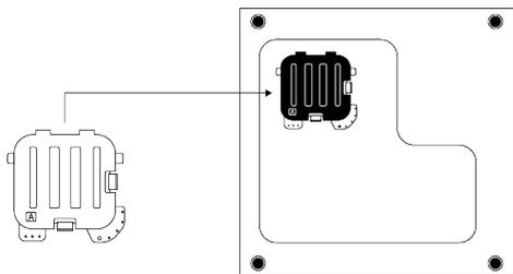
Слегка наклоните машину назад. Прижмите выступы крышки А к нижней панели. Завершите установку, повернув крышку.
