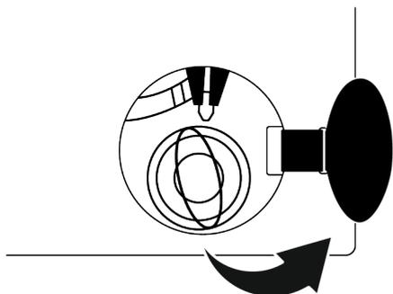
3. Потяните вниз аварийную ручку загрузочного люка с помощью инструмента и отпустите. Затем откройте загрузочную дверцу.
