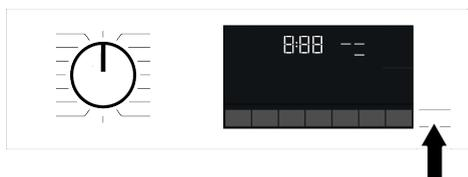
Если уровень воды в машине не подходит, когда вы нажимаете кнопку «Пуск/Пауза», блокировка дверцы не может быть деактивирована, а значок блокировки дверцы на дисплее остается включенным.
