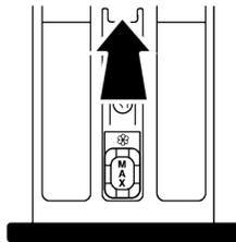
1. Нажмите на отмеченную часть сифона в отсеке кондиционера, а затем потяните ящик на себя, чтобы извлечь его.
