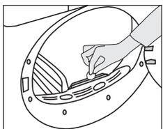
В сушильном автомате установлены датчики влажности для определения сухости белья. Чтобы очистить датчики:
