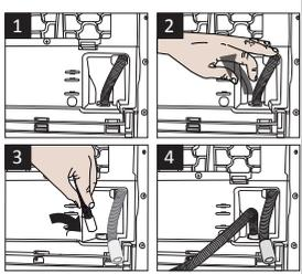
1-2 Потяните шланг в задней части сушильной машины рукой, чтобы отсоединить его в месте, где он был подсоединен. Не используйте для отсоединения какие-либо инструменты..
