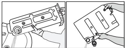
3. Если в воронке имеется слой ворса, промойте ее под проточной водой.
