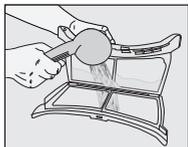
На отверстиях в фильтре может образоваться наслоение, что может привести к закупориванию фильтра после использования машины в течение некоторого времени. Промойте фильтр теплой водой для удаления наслоения, скапливающегося на поверхности фильтра. Полностью высушите фильтр перед его повторной установкой.
