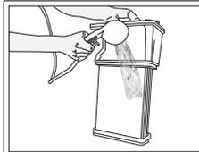
Очистите конденсатор из распылителя водой под давлением и подождите, пока она стечет.
