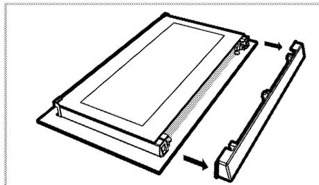
3. Heben Sie die innerste Scheibe (1) wie in der Abbildung gezeigt leicht in Richtung **A** an, ziehen Sie sie in Richtung **B** heraus.
