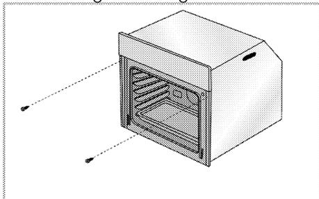
Fixieren Sie den Backofen wie in der Abbildung gezeigt mit zwei Schrauben. Stellen Sie nach der Installation sicher, dass die Schrauben ausreichend
