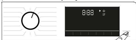
Если при нажатии кнопки «Пуск/Остановка» уровень воды в машине неприемлемый, блокировку дверцы невозможно деактивировать и ее значок на дисплее продолжает гореть.
