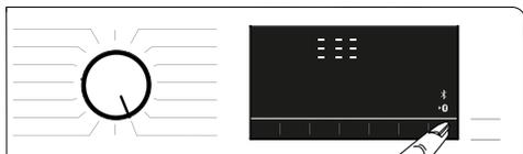
Когда функция удаленного управления включена, элементы управления стиральной машины позволяют только выключать ее и определять ее состояние. Все функции стиральной машины, за исключением блокировки от детей, управляют с помощью приложения.
