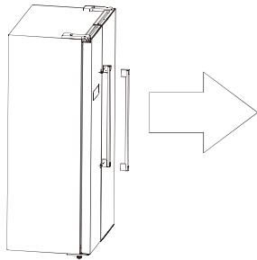
3. Dopo il posizionamento dell'apparecchio, installare le maniglie invertendo il processo.
