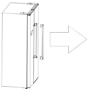
3. Nakon što je uređaj postavljen, ugradite ručke obrnutim postupkom.
