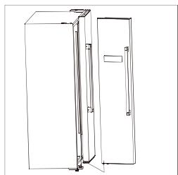
5. Schroef de onderste scharnieren los.
