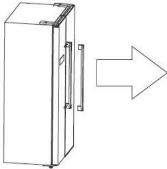
3. Po ustawnieniu urządzenia zamontuj uchwyty w odwrotnej kolejności.
