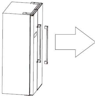
3. Une fois l'appareil positionné, installez les poignées en suivant les étapes dans l'ordre inverse.
