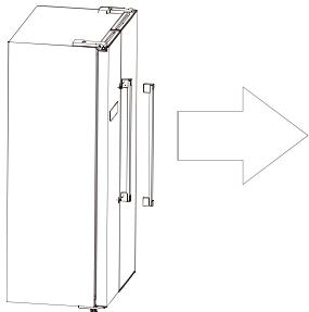
3. Nadat het apparaat is geplaatst, installeert u de handvaten in de omgekeerde volgorde.
