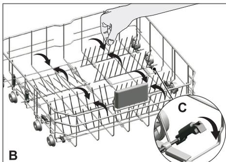
**i** Поставувањето на запците хоризонтално држејќи ги на горниот дел може да предизвика нивно извиткување. Затоа, најсоодветно е да ги поставите запците хоризонтално или вертикално држејќи ги на почетокот и туркајќи ги во правец на стрелката.
