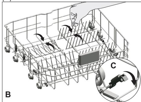
**i** Поставувањето на запците хоризонтално држејќи ги на горниот дел може да предизвика нивно извиткување. Затоа, најсоодветно е да ги поставите запците хоризонтално или вертикално држејќи ги на почетокот и туркајќи ги во правец на стрелката.
