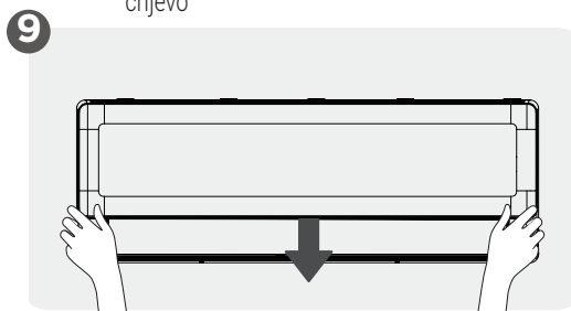
Montirajte unutrašnju jedinicu
