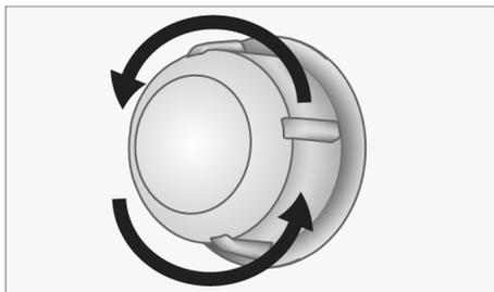
3. Ako je svjetlo vaše pećnice vrste (A) prikazano na donjoj slici tada okrenite svjetlo pećnice kako je prikazano na slici i zamijenite ga novim. Ako je model vrste (B) izvucite ga na način prikazan na slici i zamijenite ga novim.
