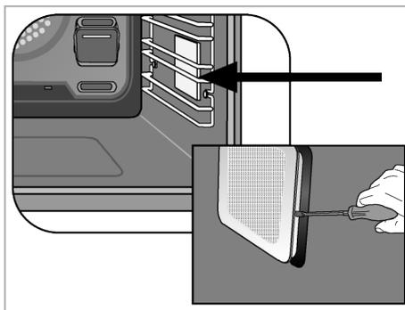
3. Podignite zaštitno staklo svjetla pomoću odvijača. Prvo uklonite vijak ako postoji vijak na četvrtastoj svjetiljci u vašem proizvodu.
