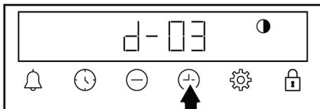
3. Dodirnite gumb ⚙️ za potvrdu ili pričekajte bez dodirivanja bilo kojeg gumba. Postavka svjetline postaje aktivna nakon nekog vremena.
