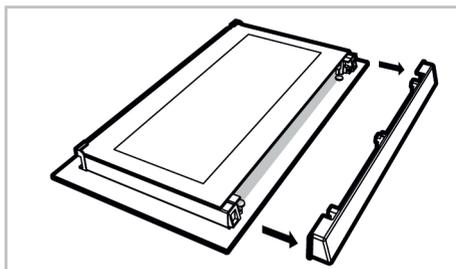
3. Kao što je prikazano na slici, lagano podignite zadnje unutarnje staklo (1) prema 'A' i zatim ga uklonite povlačenjem prema 'B'.
