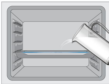
3. Réglez le four sur le mode de fonctionnement "nettoyage vapeur facile" et faites-le fonctionner à 100°C pendant 15 minutes.
