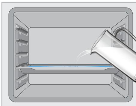
3. Podesite pećnicu na način jednostavnog čišćenja parom i pustite neka radi 15 minuta na 100°C.
