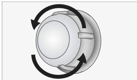
3. Si la lampe du four est de type (A) illustré dans la figure ci-dessous, tournez la lampe du four comme indiqué dans la figure et remplacez-la par une nouvelle. S'il s'agit d'un modèle de type (B), retirez-le comme indiqué sur la figure et remplacez-le par un nouveau.
