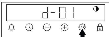
2. Željeno osvjjetljenje podesite pomoću gumba ⊕/⊖. (d-01-d-02-d-03)
