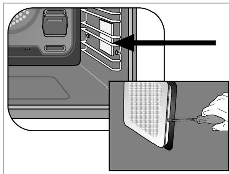
3. Soulevez le couvercle de protection en verre de la lampe à l'aide d'un tournevis. Retirez d'abord la vis, s'il y a une vis sur la lampe carrée de votre produit.
