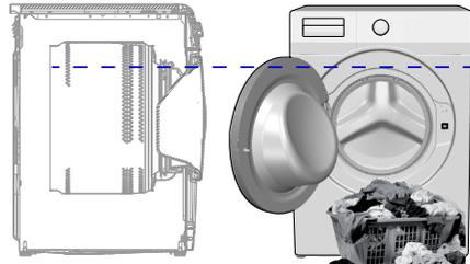
Im Waschprogramm für 4 kg und Trocknungsprogramm für 4 kg sollten Sie die Maschine für optimale Trocknungsleistung bis zum oben gezeigten Füllstand beladen (Sie sehen den Pfeil, wenn Sie die Ladetür öffnen).
