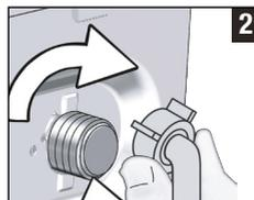
**2** Ziehen Sie die Muttern des Schlauches sicher von Hand fest. Ziehen Sie die Muttern niemals mit einem Werkzeug an.
