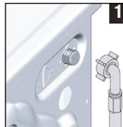
**1** Schließen Sie den mit der Maschine gelieferten Spezialschlauch an den Wasserzulauf des Gerätes an.
