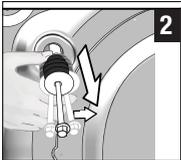
**2** Entfernen Sie die Transportsicherungen, indem Sie diese vorsichtig herausdrehen.
