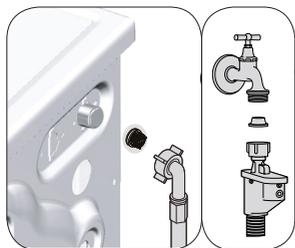
Am Endstück jedes Wasserzulaufventils an der Rückseite der Maschine sowie am Ende der Wasserzulaufschläuche (dort, wo diese an den Wasserhahn angeschlossen werden) befindet sich ein Filter. Diese Filter verhindern, dass Fremdkörper und Schmutz mit dem Wasser in die Waschmaschine gelangen. Die Filter sollten gereinigt werden, sobald sie schmutzig sind.
