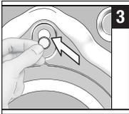
**3** Setzen Sie die Kunststoffabdeckungen (diese finden Sie in der Tüte mit der Bedienungsanleitung) in die Löcher an der Rückwand ein.
