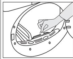
Ihr Trockner arbeitet mit Feuchtigkeitssensoren, um den Trocknungsgrad der Wäsche zu erkennen. So reinigen Sie die Sensoren:
