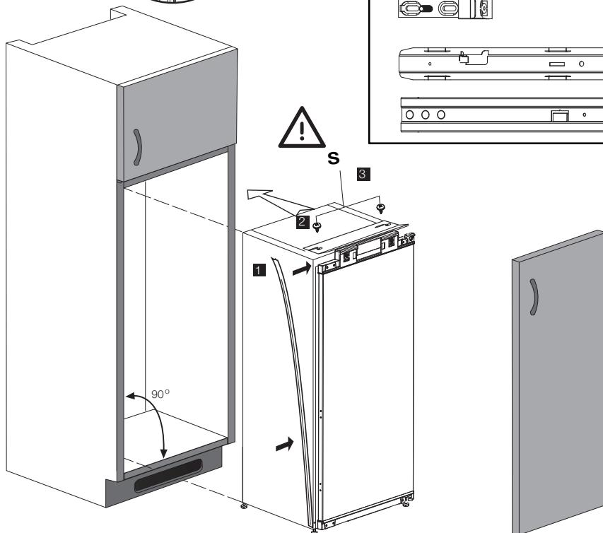
**Not:** 2-3 numara ile gösterilen montaj adımında üst bağlantı plastikini kaydırabilmek için bağlantının yapıldığı vidaları tam sıkmayıniz.
