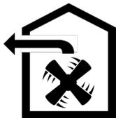
Die Luft, die aus der Mitte des Herdes angesaugt wird, passiert die Ölfilter und wird über den Schornstein mit einem Rohrsystem nach außen abgeführt.
