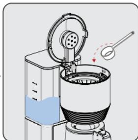
Otvorite poklopac odeljka za kafu i dodajte dovoljno kafe da napravite kafu. Zatim zatvorite poklopac odeljka za kafu.
