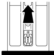
1. Premir a parte marcada do sifão dentro do compartimento do amaciador e depois puxar a gaveta em direção a si para a retirar.
