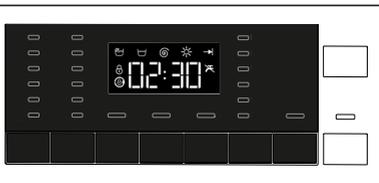
Ein spezielles Sicherungssystem verhindert das Öffnen der Tür, solange der Wasserpegel innerhalb der Maschine noch nicht als sicher gilt. Die „Tür verriegelt“-Leuchte leuchtet am Panel auf, wenn die Tür verriegelt ist.
