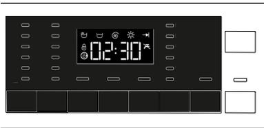
Das Programm wird abgebrochen, wenn die Maschine aus- und wieder eingeschaltet wird. Drücken Sie die Taste **Ein / Aus** und halten Sie sie 3 Sekunden lang gedrückt. Nach Ablauf des Countdowns („3-2-1“) im Display schaltet sich die Maschine aus.
