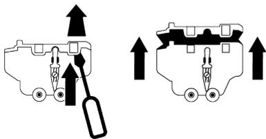
7. Os encaixes que suportam a tampa superior da gaveta do detergente são removidos com uma chave de fendas de cabeça plana (existem no total 6 encaixes, dois do lado direito, no lado esquerdo e na traseira da gaveta) e o interior da gaveta é lavado.
