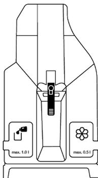
2. Para encher com o detergente líquido (esquerdo) e o amaciador (direito), abrir a tampa dos depósitos respetivos puxando-os para cima conforme mostrado na imagem.
