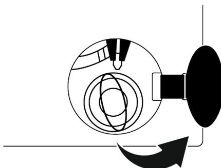
3. Empurrar a pega de emergência da porta de carregamento para a abrir. Em seguida, abrir a porta de carregamento.
