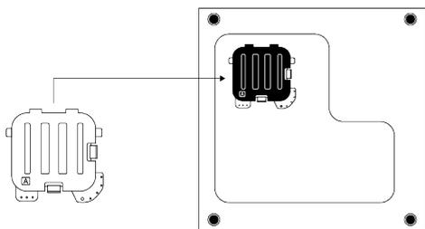
Inclinar a máquina ligeiramente para trás. Assentar as guias da Tampa A contra o painel inferior. Completar a montagem rodando a tampa.
