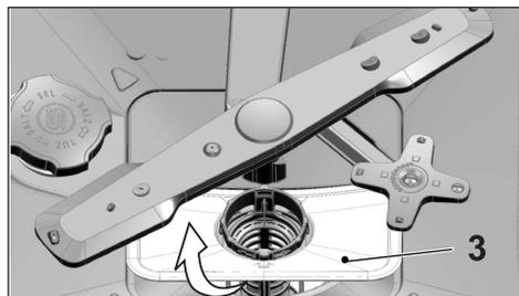
3. Pressione os dois trincos do filtro grosso para dentro e separe o filtro grosso do conjunto.
