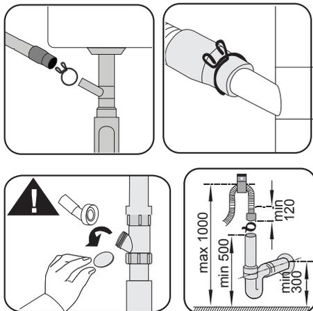
**i** O tubo de escoamento deve estar ligado ao sistema de esgotos e não deverá ser ligado a qualquer superfície aquosa.
