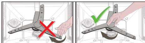
**i** Não tente rodar o propulsor segurando as suas extremidades. Tentar rodar as extremidades pode causar a quebra do sistema de engrenagens do propulsor.
