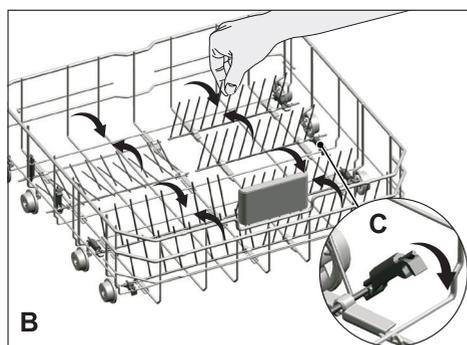
**i** Fazer os separadores voltar à posição horizontal segurando-os pelas pontas pode fazer com que se dobrem. Portanto, será apropriado fazê-los voltar à posição intermédia ou vertical segurando-os pelas hastes e empurrando na direção das setas.
