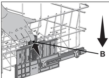
**i** O mecanismo de movimento pode não funcionar corretamente se o cesto superior estiver sobrecarregado ou se a distribuição do peso não estiver equilibrado. Em condições mais pesadas, não existe o risco de descer um nível.
