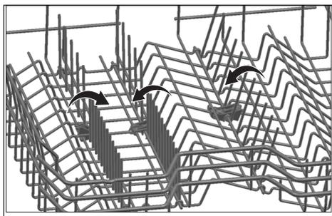
**i** Faça as grelhas voltarem à posição horizontal segurando-as pelas pontas pode fazer com que se dobrem. Assim, deve segurar as grelhas a partir das hastes enquanto as coloca na posição horizontal ou vertical.
