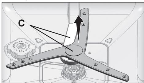
Para retirar e limpar o conjunto do propulsor inferior, segure nos pontos mostrados na figura (C) com uma mão e puxe para cima para os retirar. Após a limpeza, siga estes passos na ordem inversa para reinstalar o conjunto do propulsor.
