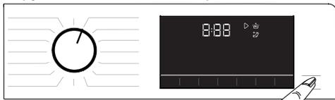
Если при нажатии кнопки **Пуск/остановка** уровень воды в машине неприемлемый, отобразится сообщение о том, что дверца загрузки заблокирована.
