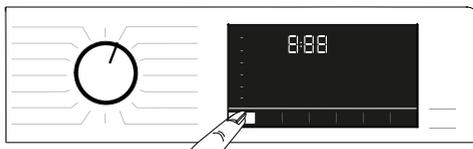
При выборе программы на индикаторе температуры отображается температура, рекомендованная для данной программы. Возможно, что температура, рекомендованная для данной программы, не является для нее максимальной. Чтобы понизить температуру, нажмите кнопку **Регулировки температуры**.
