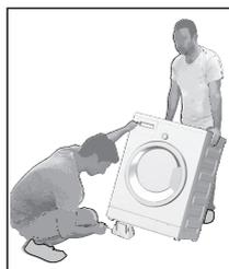
Чтобы удалить элементы жесткости, наклоните машину назад. Удалите элементы жесткости, присоединенные к ленте.
