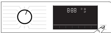
Нажмите кнопку **Пуск/остановка**, чтобы переключить машину в режим остановки.
