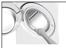
После каждой стирки и сушки проверяйте барабан на наличие посторонних предметов. Если показанные на рисунке ниже отверстия засорены, очистите их с помощью зубочистки.
