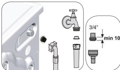
Фильтры находятся на концах впускных патрубков для воды на задней стенке машины, а также на концах заливных
