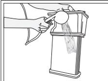
Очистите конденсатор из распылителя водой под давлением и подождите, пока она стечет.
