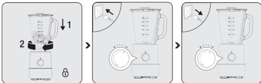
Установите стеклянный контейнер (3) на блок электродвигателя (6) вертикально, поверните его до символа «0», чтобы зафиксировать на своем месте.
