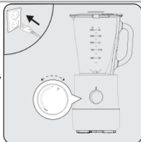
Conectați aparatul la priză și puneți-l în funcțiune prin selectarea nivelului de viteză (7).
