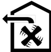
Die Luft, die aus der Mitte des Herdes angesaugt wird, passiert die Ölfilter und wird über den Schornstein mit einem Rohrsystem nach außen abgeführt.
