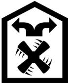
Die aus der Mitte des Herdes angesaugte Luft wird zunächst vom Öl gereinigt, indem sie durch den Ölfilter geleitet wird. Anschließend wird es durch einen Aktivkohlefilter geleitet und zurück in die Küche geleitet.
